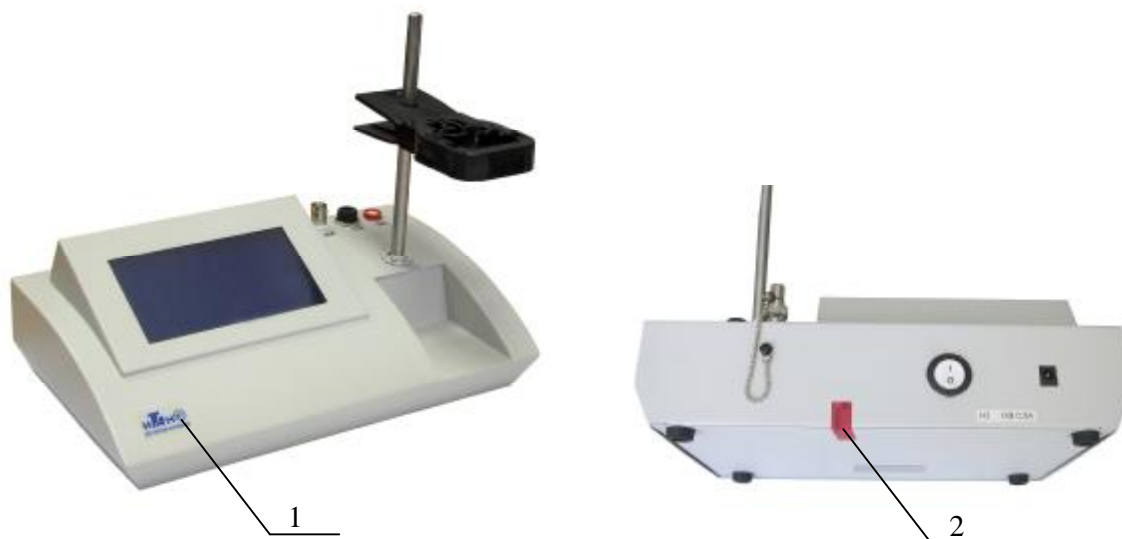
1 – место нанесения знака утверждения типа; 2 - место пломбировки от несанкционированного доступа
